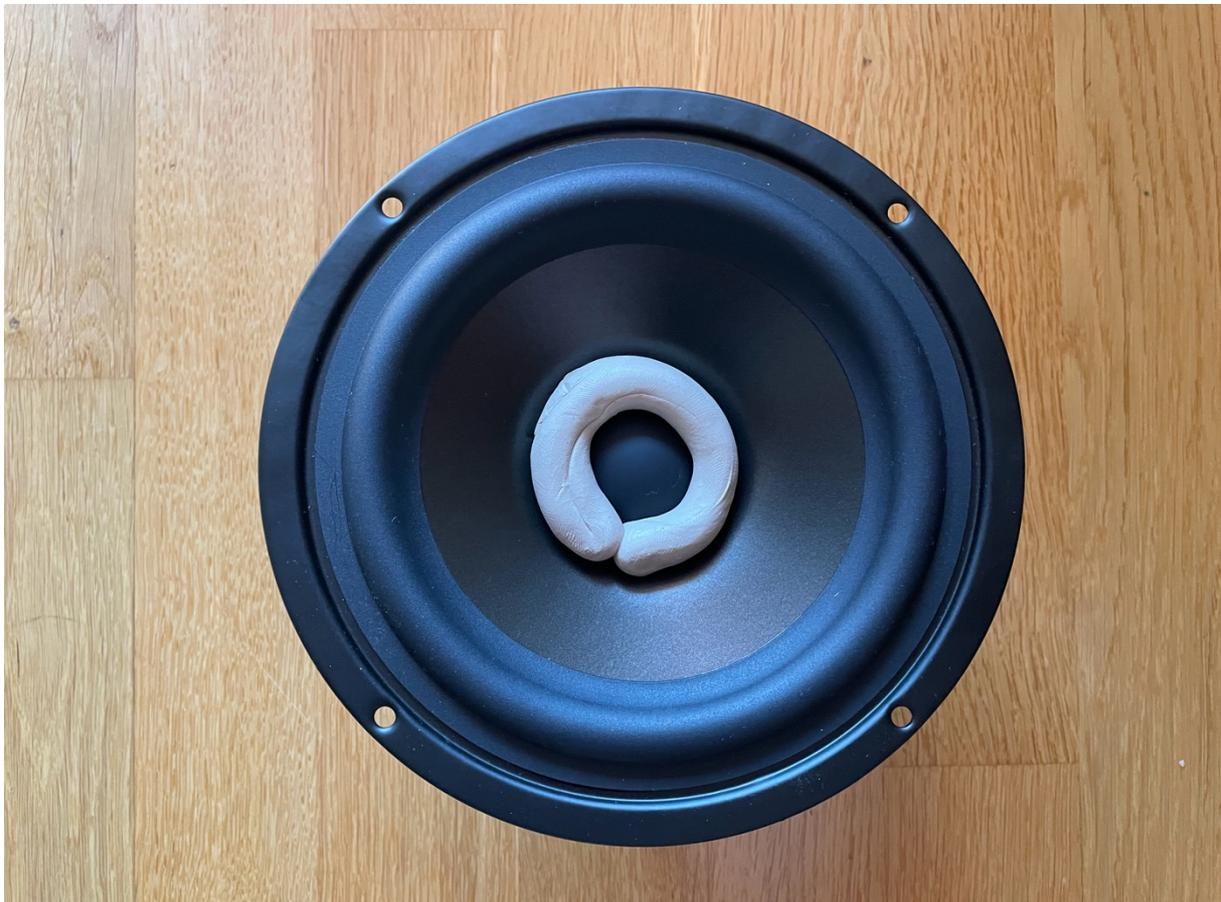
Die Knete oder das Plastic-Fermit können entweder als Kugel auf der Dustcap, oder wie hier gezeigt als „Wurst“ um die Dustcap herum angebracht werden. Das Gewicht wurde mit einer Briefwaage (landläufig auch als „Kifferwaage“ bezeichnet 🤪 ) bestimmt. Eine Waage mit 2 Nachkommastellen reicht vollkommen aus.
